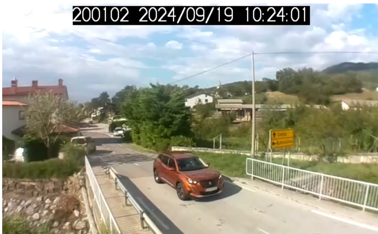
Slika 5: Štetje prometa z metodo videodetekcije
